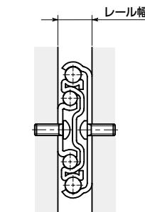
スライドレールを操作した際に、2本1組のペアが同時に全開位置・全閉位置へ到達するように取りつけてください。ボールケージは正しい位置に配置するために、取りつけ前に一度インナースライドを全開位置・全閉位置まで動かしてください。
