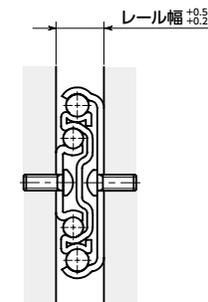
スライドレールを操作した際に、2本1組のペアが同時に全開位置・全閉位置へ到達するように取り付けてください。ボールケージは正しい位置に配置するために、取り付け前に一度インナースライドを全開位置・全閉位置まで動かしてください。
