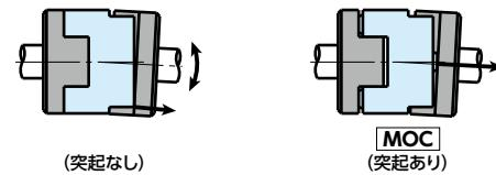
スペーサに突起のないオルダムタイプカップリングでは、スペーサとハブが外径付近で干渉するため、許容偏角が小さく、また、軸に曲げモーメントが発生します。
