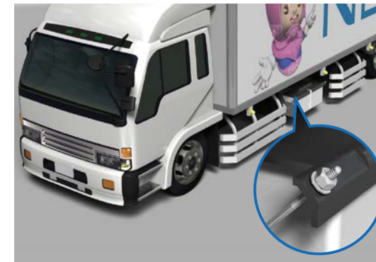
トラックのバッテリーの盗難防止
