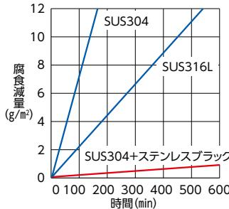
塩酸性6% 塩化第二鉄溶液中での試験片の腐食減量を単位時間で比較したグラフです。
