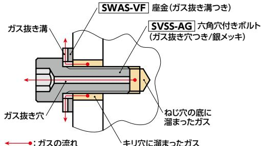
● ガス抜き穴が機器・装置のねじ穴の底に溜まつたガスを排出しやすくなり、真空装置の真空引きをサポートします。
